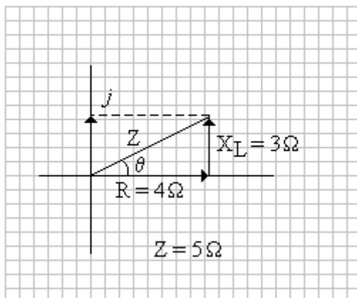
Em termos elétricos, uma impedância complexa  $4 + j3$  significa  $4\Omega$  de resistência elétrica e  $3\Omega$  de reatância indutiva. Lembrar que, a impedância  $4 + j3$  está escrita na forma retangular.
