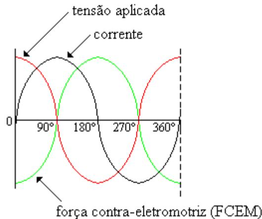
**CONCLUSÃO:** Qualquer circuito AC que contenha apenas indutância apresenta três variáveis importantes: a) *tensão aplicada*; b) *força contra eletromotriz induzida* e c) *corrente do circuito*. FCEM: é a voltagem contrária originada num circuito indutivo pela passagem de uma corrente alternada ou pulsativa.
