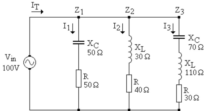
Calcule as correntes  $I_1$ ,  $I_2$  e  $I_3$ ; as impedâncias  $Z_1$ ,  $Z_2$  e  $Z_3$ ; a corrente total ( $I_T$ ) e a impedância total ( $Z_T$ ) nas formas retangular e polar.
