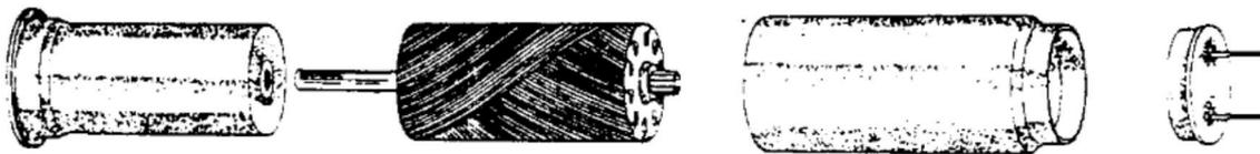
**Fig. 7.13** Vista do enrolamento de uma máquina CC em ímã permanente de Alnico
