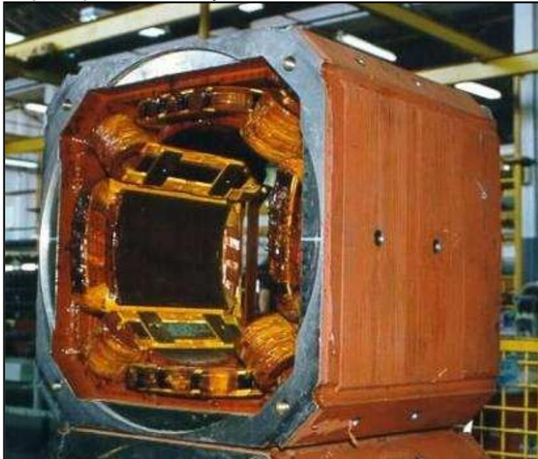
**Fig. 7.3** Carcaça de uma máquina de corrente contínua.
