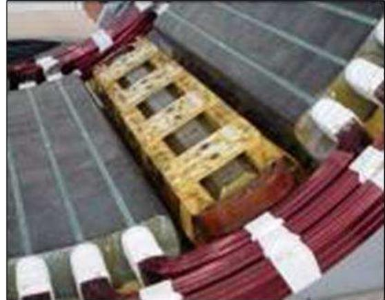
**Fig. 7.5** Pólos de compesação de uma máquina de corrente contínua.
