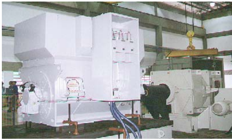
Figura 1.120 – Ensaio de um motor da linha “M” de alta tensão
