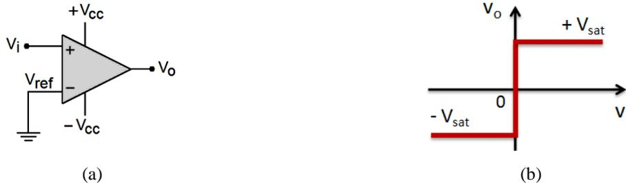
Figura 3.76 – (a) Detector de nível zero. (b) Resposta de um AOP comparador convencional.
