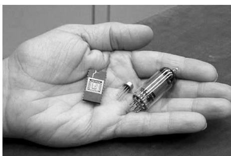
Figura 2.4 – Comparação em dimensão de um CI (circuito integrado) com um TJB e uma válvula (PIROPO, 2012).
