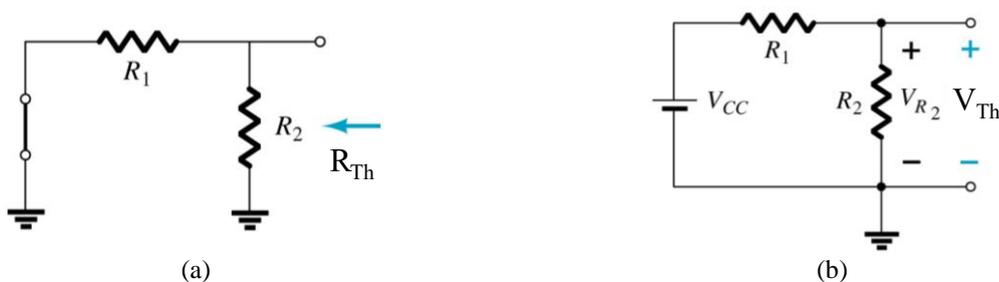
Figura 2.70 – (a)  $R_{Th}$  do circuito da Figura 2.69b. (b) Tensão  $V_{Th}$  (BOYLESTAD e NASHELSKY, 2004).
