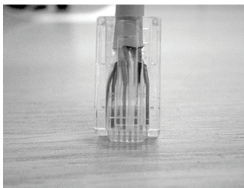
Figura 42: Modo de conectar os fios ao conector
