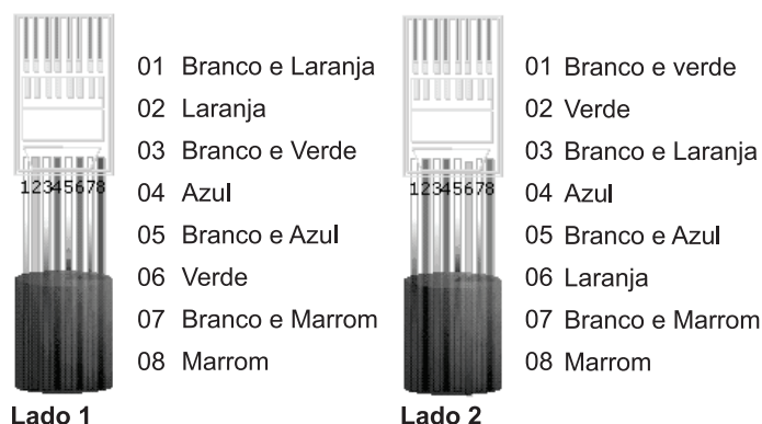
Figura 41: Separação dos cabos para Crimpagem
