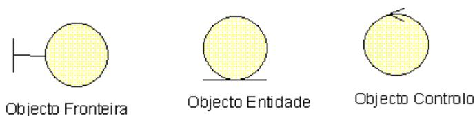
*Figura 11.13: Tipos de objectos usados os diagramas de robustez.*
