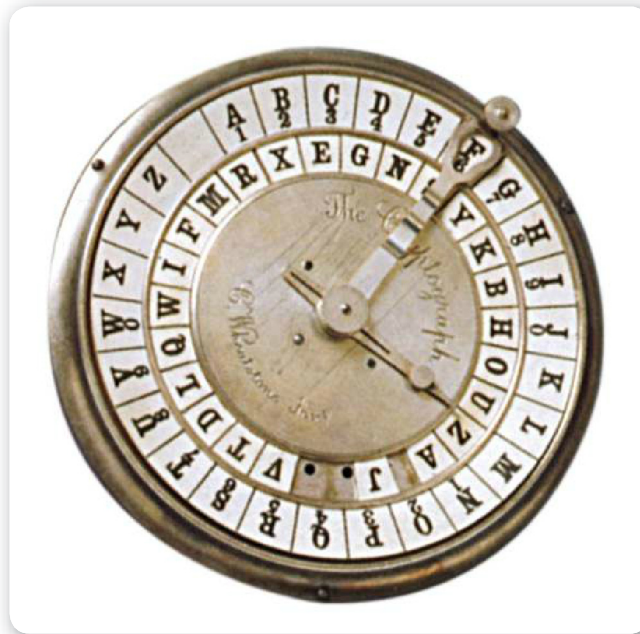
Figura 8. El disco de Wheatstone permite cambiar el alfabeto de cifrado por cada vuelta de las agujas, que solo se mueven en sentido horario.
