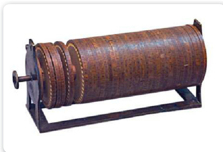
Figura 9. El disco de Jefferson o de Bazeries aplicaba un sistema de ruedas con letras mediante el que se transformaba el mensaje.
