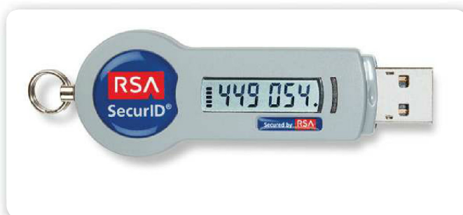
Figura 13. El firmado digital puede realizarse también con dispositivos físicos, llamados normalmente tokens criptográficos .
