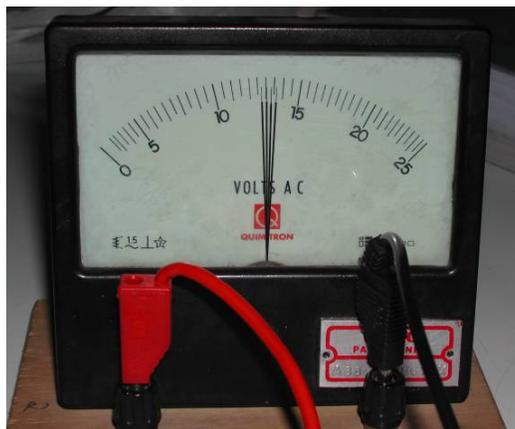
FIGURA 6 - Voltímetro analógico durante uma medição de uma tensão elétrica alternada
