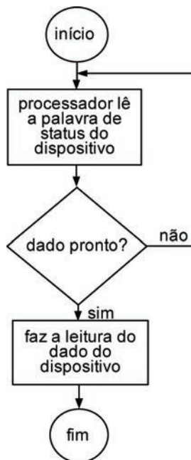
Figura 138 Fluxograma de uma rotina de entrada de dados por polling .
