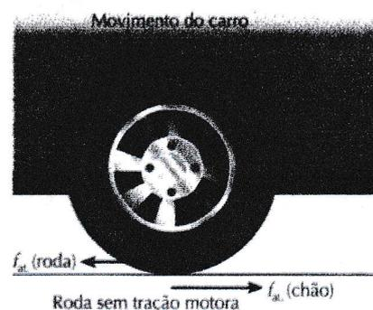
Um carro de tração traseira possui o eixo traseiro das rodas ligado ao motor. As rodas traseiras têm tração motora, e as da frente, não. Há carros de tração dianteira e de tração nas quatro rodas. Ao acelerarmos o carro, as forças de atrito nas rodas de tração têm o mesmo sentido do movimento do automóvel; nas rodas não-tracionadas, têm sentido oposto.
