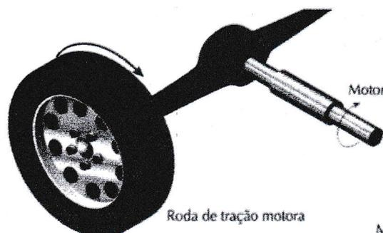
Quando aceleramos um carro, as rodas de tração motora "empurram" o chão para trás e, pelo princípio da ação-e-reação, o chão exerce uma força de mesma intensidade e sentido contrário, movimentando o automóvel para a frente.
