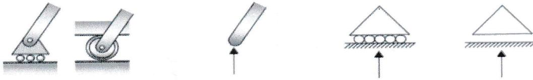
**Apoio fixo**, é um tipo de apoio que impede o movimento nas direcções normal e paralela ao plano, porém mantém o apoio livre para rotação, dessa forma, pode ter força de reacção de apoio no sentido horizontal e vertical, como mostra a Figura abaixo.
